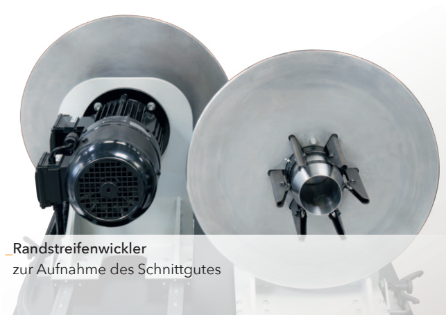
Wickler diskontinuierlich, mit fliegend gelagerten Expansionswellen für einfaches Handling
