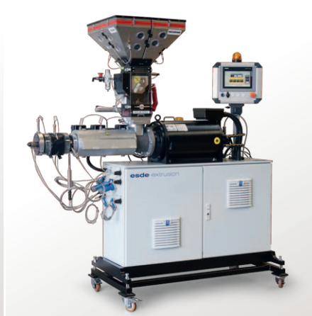
ESE 1-25-18 Laborextruder mit Dosierstation: ideal zur Entwicklung neuer Rezepturen
